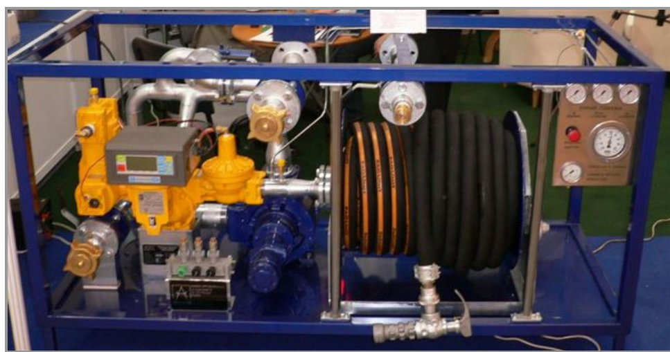
Instalacja autocysterny z przepływomierzem MA-7
